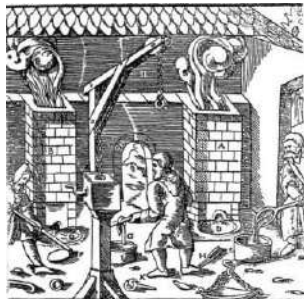
1556 - pece: A: přetavování strusek, B: výroba slitiny Cu a Pb (Agricola 2001, 474).
