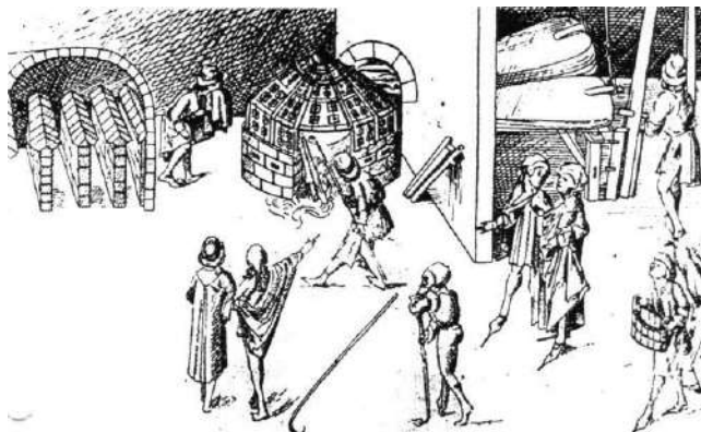
1480 - náčrt považován za nejstarší známý obraz vnitřku měděné huti, kde se současně získávalo stříbro (History of Technology, díl III., obr. 35 b)
